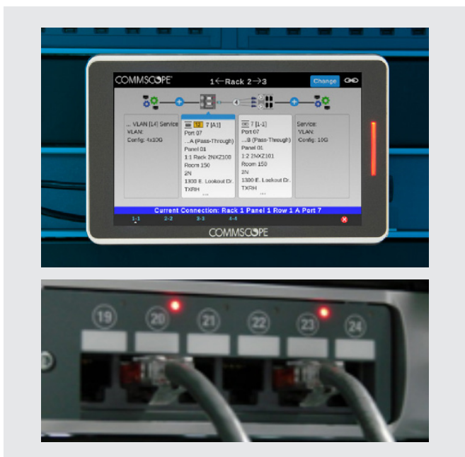
Figuur 1: imVision biedt instructies op het scherm en visuele hulp voor poortconnectiviteit om ervoor te zorgen dat wijzigingen correct plaatsvinden.
