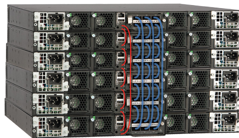
Figura 4: Se pueden apilar hasta 12 switches Ruckus ICX 7750 utilizando hasta 12 puertos QSFP+ estándar full-duplex de 40 Gbps por switch, lo que proporciona hasta 5,76 Tbps de ancho de banda de apilamiento agregado.
