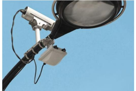
上图：Ruckus室外AP安装在灯柱上，配有专用电源适配器，该适配器利用PoE输出功能为更多AP和基于IP的交通摄像头等其他设备供电。
