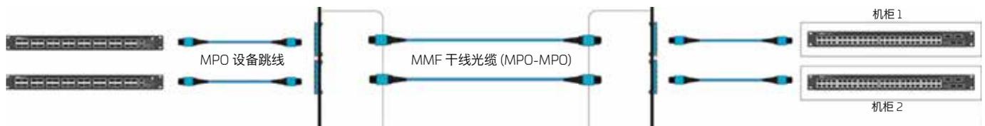
图 1: 采用 MPO 并行光纤基础设施的 SR4 交换机连接。
